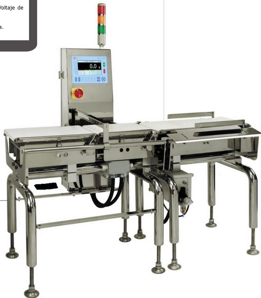
Máquina automática para la verificación de peso de tipo dinámico, marca TECNI PAC®, modelo TINT810-SWL-615, con sistema de rechazo tipo "electric sol" (Opcional), transportador de entrada, transportador bascula electrónica tipo dinámico, transportador de salida con Sistema de rechazo del producto fuera del peso predeterminado.
