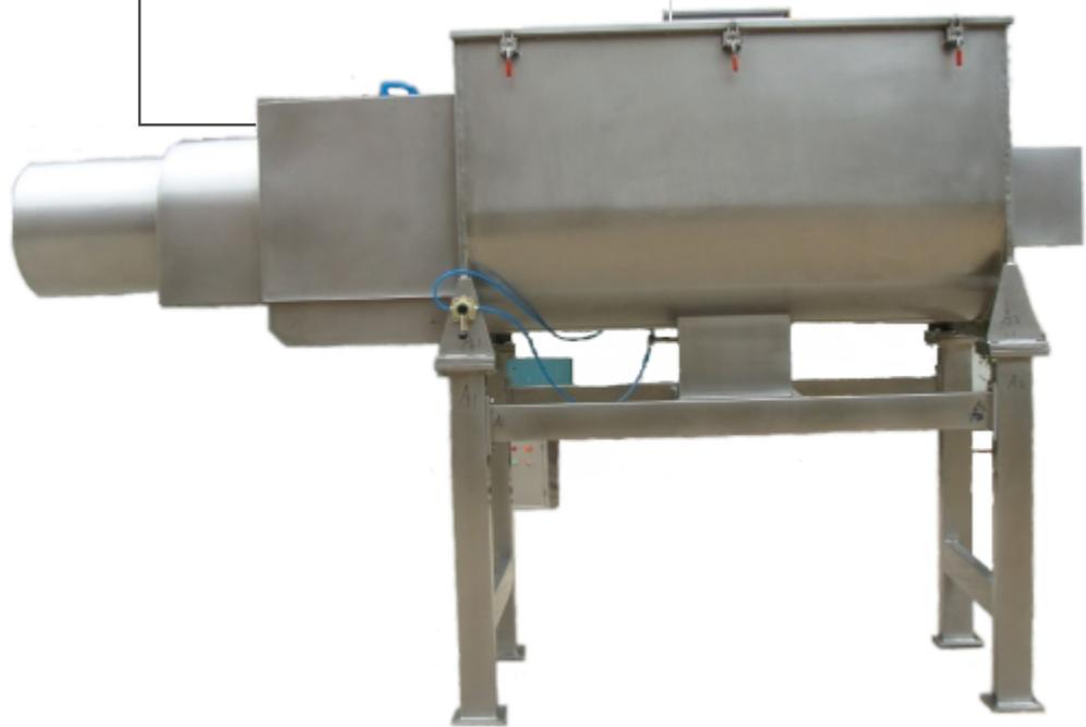
Maquina mezcladora de tipo listón horizontal marca TECNI PAC® Modelo TRBH-1 fabricada para uso farmacéutico y alimenticio, en el mezclado de productos de polvo o pastas en forma uniforme sin producir efectos de deterioro.
